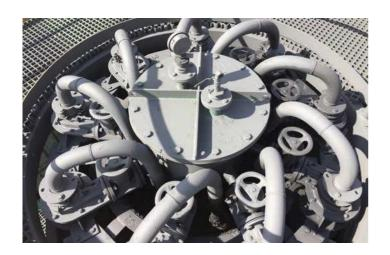
Vannes PVEG, Corps polyamide, DN 50, à commande manuelle, utilisées dans un hydrocyclone dans la mine de KARA en Tasmanie - Australie.
