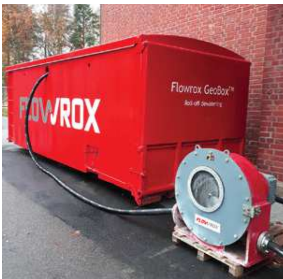
Vue extérieure du système GeoBox avec une pompe de transfert LPP-T65.
