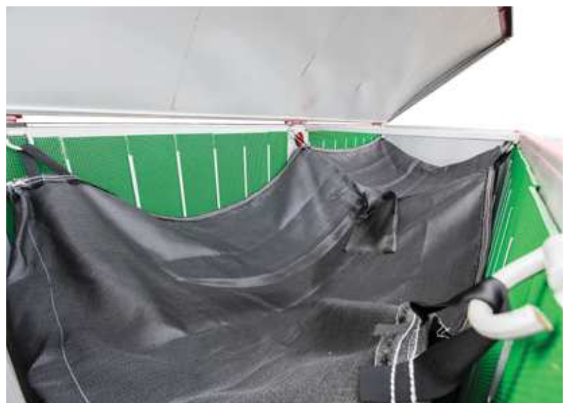
Le sac filtrant en géotextile est fixé à l'intérieur du container.
