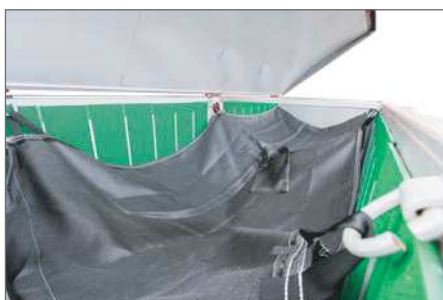
Le sac géotextile sépare efficacement les solides de l'eau.
