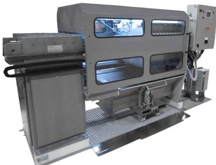
AF 630 avec panneau de contrôle et collecteur de boue mobile.
