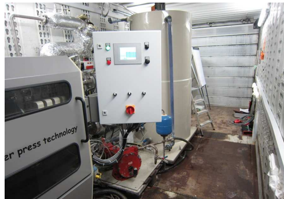
Les filtres d'essai AF 470 Mini et AF 800 sont installés et transportables dans un container pour être facilement déployés chez le client.
